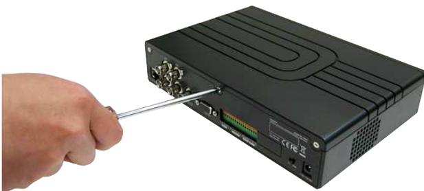
2. Retire la cubierta superior empujándola y levantándola
