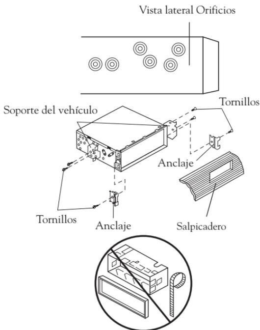
**Nota:** El marco embellecedor, la faja de montaje y la tira metálica no se utilizan en la instalación DIN trasera.
