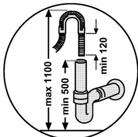
Conecte sin doblar el tubo de desagüe del lavavajillas a la cañería de desagüe de su instalación. Si la longitud del tubo no fuera suficiente, solicite una extensión del mismo tipo al servicio de asistencia técnica autorizado. Recuerde que la longitud del tubo no puede exceder de 4 metros incluyendo la extensión. Si la conexión de desagüe es más larga de 10 metros, la vajillas no se limpiará en condiciones.
