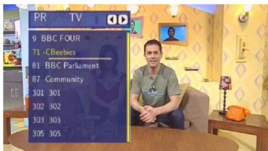
Con IZQUIERDA/DERECHA puede cambiar entre listado de Radio y TV. PREV/NEXT sirve para saltar entre páginas. y con ARRIBA/ABAJO podrá resaltar el canal deseado. Confirme con ENTER.
