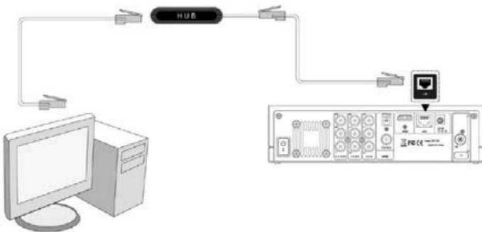
Ethernet o similar (Switch, HUB...), o directamente a su PC mediante cable cruzado.
