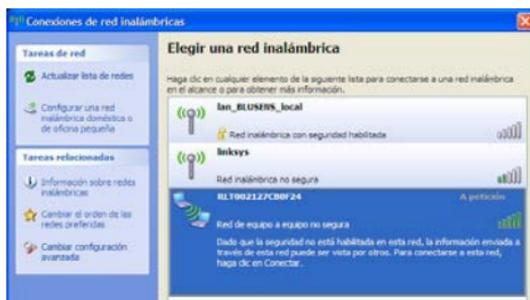
Se mostrará una lista de redes disponibles. Si el SSID que usted desea no aparece en la lista, actualícela e inténtelo de nuevo. Seleccione el SSID Wireless que está configurado como Ad Hoc. Se le requerirá la clave de acceso si no es una red abierta.
