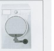
3) L'eau de pompage va sous la boule, ensuite la boule tombe et permet à l'eau de sortir de la cuve. Après, l'eau de pompage qui reste dans le tuyau de sortie revient et soulève la boule au bord du cachetage de la durite cuve filtre
