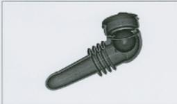
Dans la partie supérieure de la durite est située une boule. La durite est formée pour avoir le bord de cachetage au dessus de la boule. A une certaine distance au-dessous de la boule, le tuyau est formé pour prévenir la sortie de la boule pendant la vidange et de ce fait générer l'écoulement
