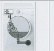
2) Quand le remplissage d'eau se fait, la boule maintient les détergents dans la cuve. Pratiquement toute la quantité de détergent est impliquée dans le processus de lavage
