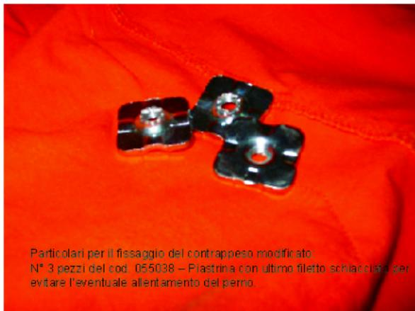
Particolari per il fissaggio del contrappeso modificato
