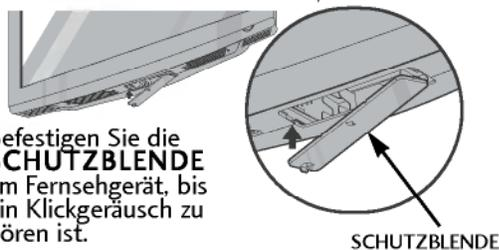
Befestigen Sie die **SCHUTZBLENDE** am Fernsehgerät, bis ein Klickgeräusch zu hören ist.
