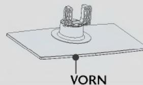
Achten Sie bei der Montage des Standfußes auf die korrekte Ausrichtung der Vorder- und Rückseite des Standfußes.
