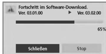
Die Software wird bei ausgeschaltetem Gerät heruntergeladen. Beim Einschalten des Gerätes während eines Updates wird der Fortschritt der Aktualisierung angezeigt.
