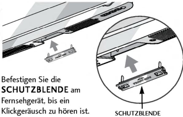
Befestigen Sie die **SCHUTZBLENDE** am Fernsehgerät, bis ein Klickgeräusch zu hören ist.
