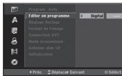
3. Utiliser les touches de direction ▲ / ▼ pour sélectionner l'option [Analog] si on souhaite ajouter une chaîne analogique, [Digital] dans le cas d'une chaîne numérique, puis appuyer sur ►.
