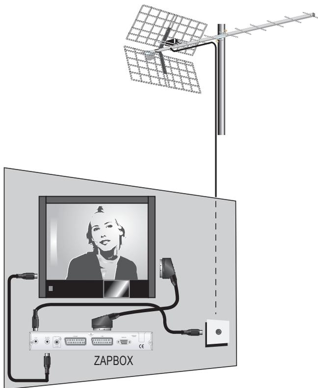
Note : le câble d'antenne entre l'adaptateur et le téléviseur permet de conserver les chaînes locales (en analogique).
