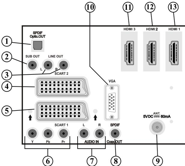
1. La **Salida digital S/PDIF** envía las señales de audio digital de la fuente que se esté visualizando. Utilice un cable óptico digital para enviar las señales de audio a un aparato que cuente con una entrada S/PDIF.
