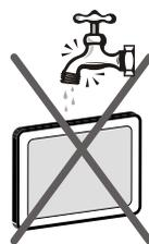
En caso de que algún líquido u objeto sólido se introduzcan en el interior del televisor, desenchúfelo y contacte con personal técnico para que lo revisen antes de ponerlo en marcha de nuevo.
