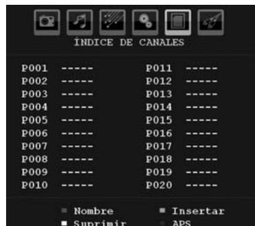
Moviendo el cursor en las cuatro direcciones puede llegar a 20 canales en la misma página. Puede desplazarse hacia arriba o abajo por las páginas pulsando los botones de navegación para ver todos los canales en el modo TV (excepto en los modos AV). Al mover el cursor, la selección de programas se realiza automáticamente.
