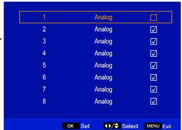
Use ▲▼ para elegir el canal que quiere seleccionar y puse OK para seleccionar o deseleccionar los canales que desee. Si selecciona este canal, aparecerá marcado con un ✓. Todos los canales seleccionados serán omitidos cuando oprima los botones de CH-/+ , podrá acceder directamente pulsando los botones números referentes al canal.
