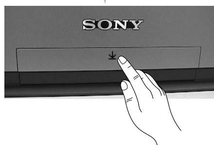
Interruptor de modo standby
