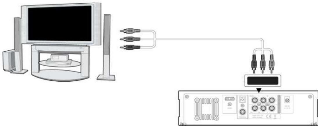
**Siga el método de conexión de audio detallado abajo:**
